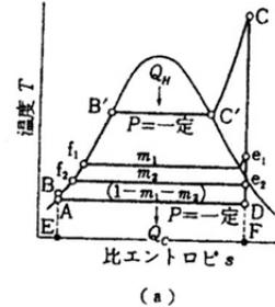
図 53 蒸気再生サイクルの線図
